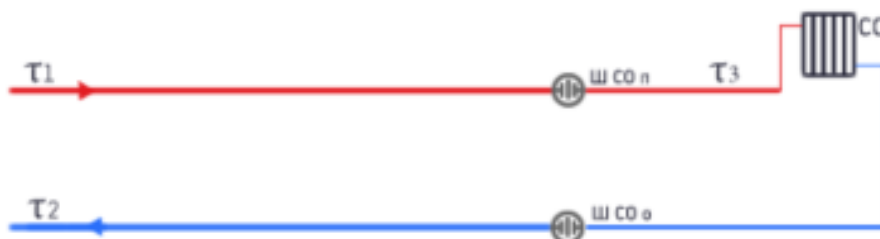
Рисунок 23. Схема присоединения потребителей к тепловым сетям котельной №5 п. Мысовой
