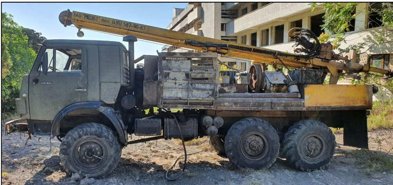
Рисунок 2.2.1.1. Общий вид установки УРБ 2А-2
