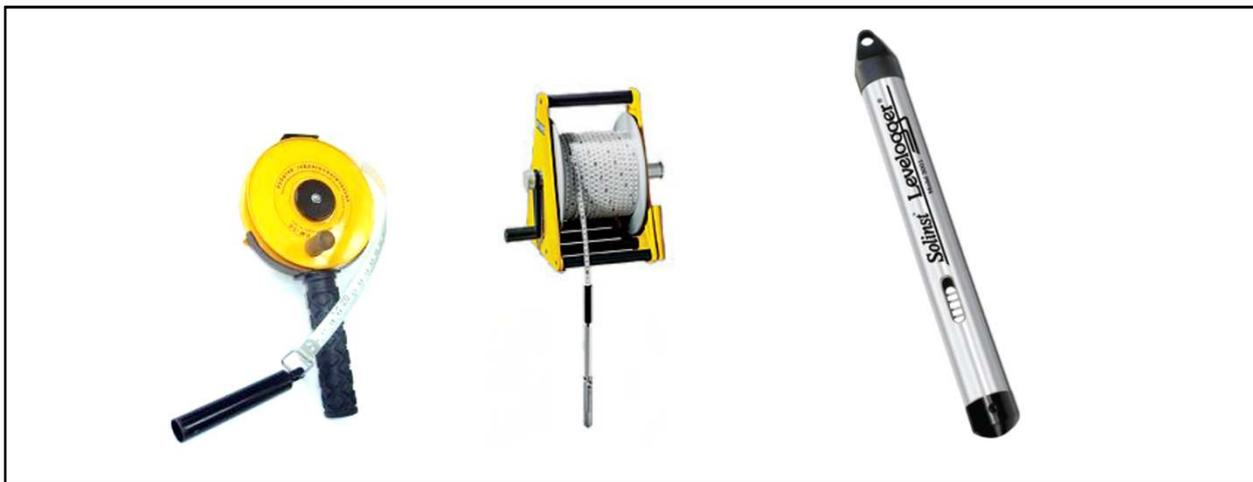
Рисунок 2.2.1.2. Гидрогеологическая хлопушка (слева) и электроконтактный уровнемер KL 010-ТМ (в середине), гидрогеологические датчики Solinst Levellogger (справа)
